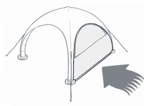
Um zu verhindern, dass sich das Zelt durch Windböen bewegt oder aufbläht, platzieren Sie mindestens eine Seitenwand in Richtung des Windes.
